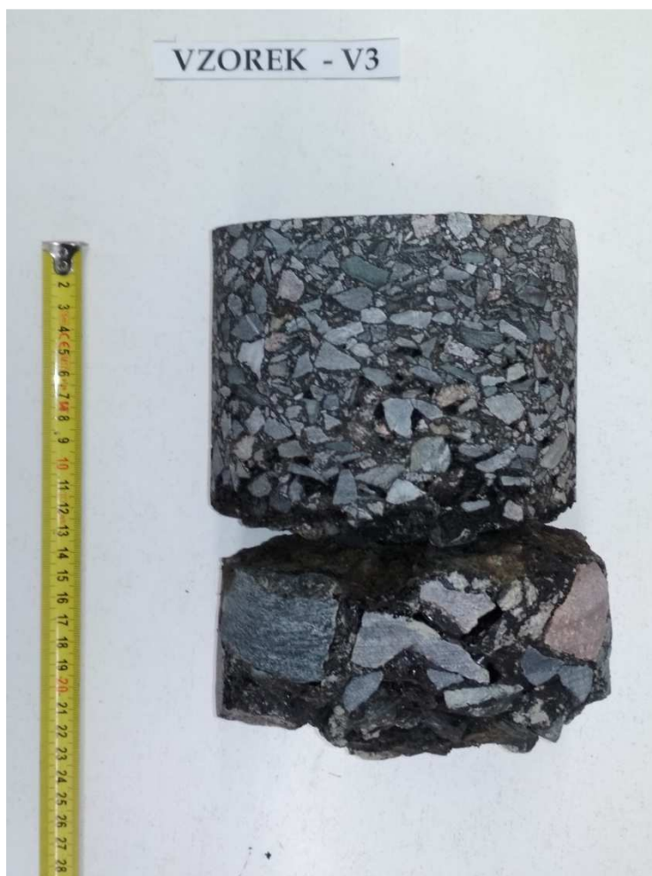
Obr. 6 - Jádru vývrtu Vzorek – V3 (laboratoř).
