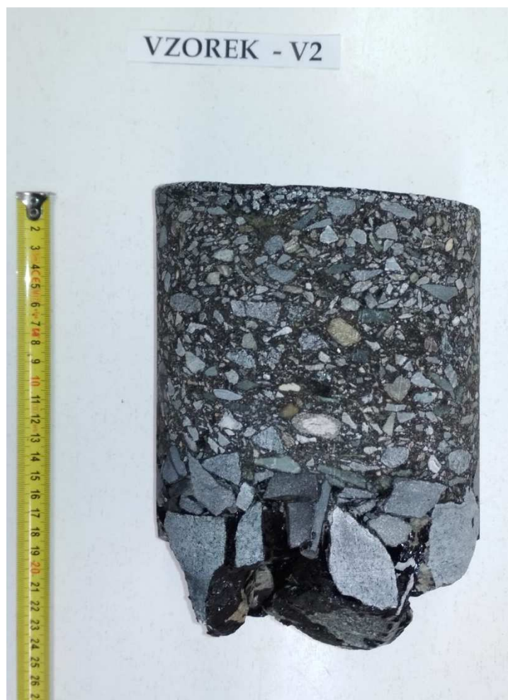
Obr. 4 - Jádru vývrtu Vzorek – V2 (laboratoř).
