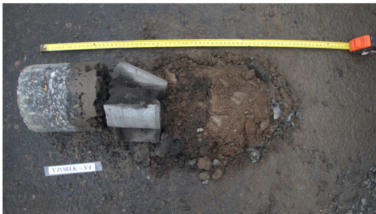
Obr. 7 - Jádro vývrtu Vzorek – V4 (in situ).
