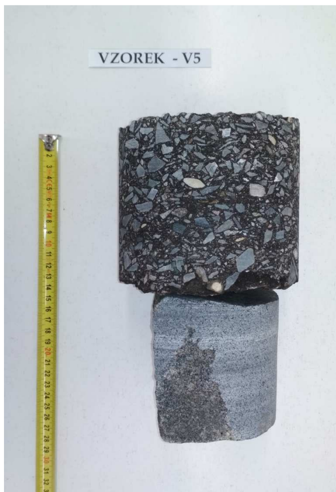
Obr. 10 - Jádro vývrtu Vzorek – V5 (laboratoř).
