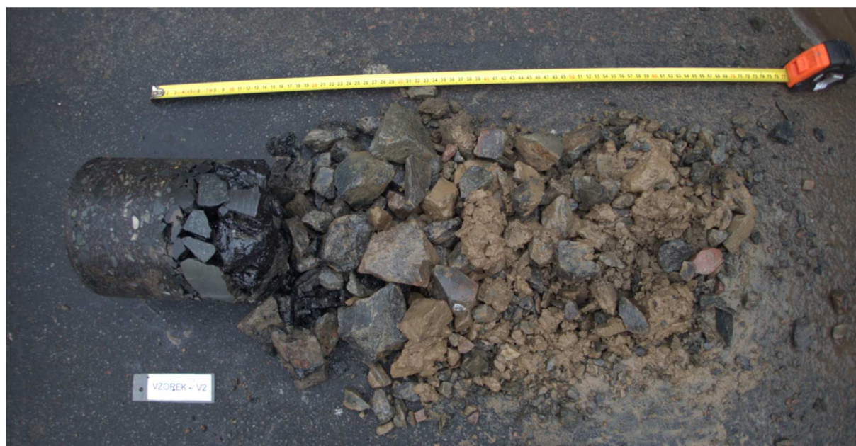
Obr. 3 - Jádro vývrtu Vzorek – V2 (in situ).
