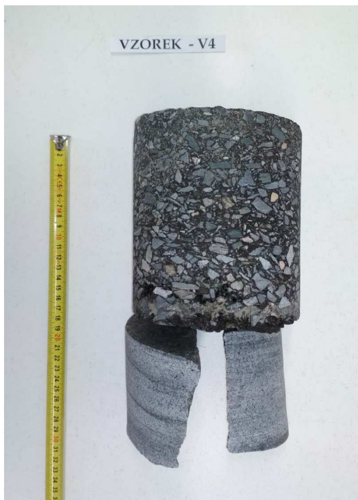
Obr. 8 - Jádru vývrtu Vzorek – V4 (laboratoř).
