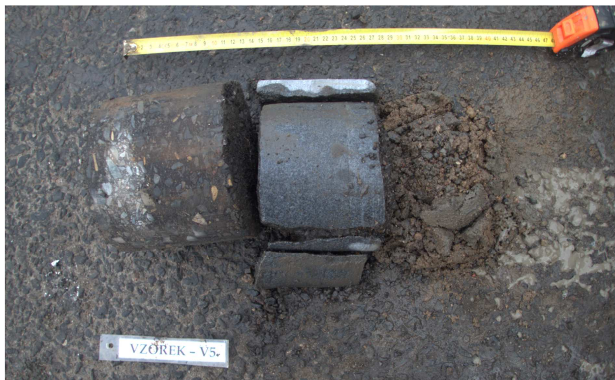
Obr. 9 - Jádro vývrtu Vzorek – V5 (in situ).
