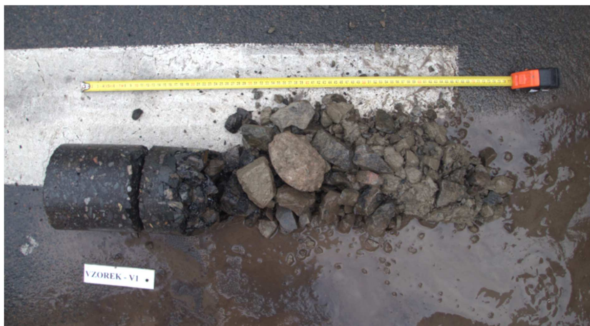
Obr. 1 - Jádro vývrtu Vzorek – V1 (in situ).
